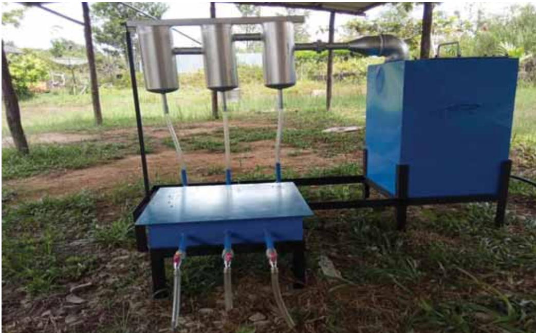
Pirolisator, alat pengubah sampah plastik menjadi BBM
