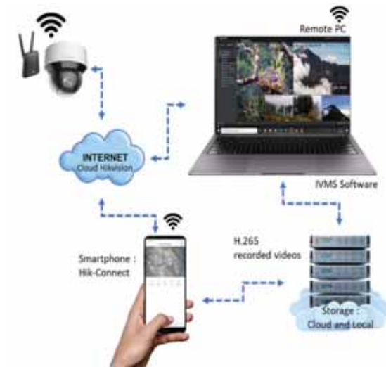
Ilustrasi cara kerja IP camera untuk pengamatan elang flores.
